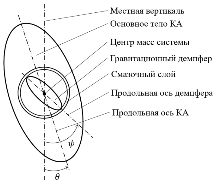
Рисунок 1 – Схема КА с гравитационным демпфером
